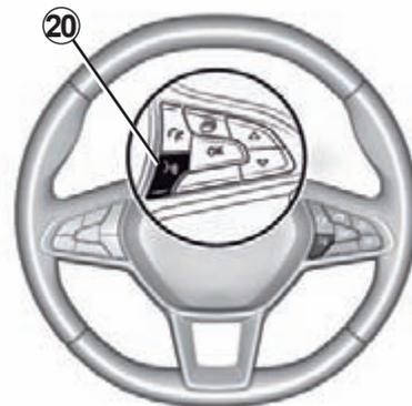
После запуска приложения «Android Auto™», «Яндекс.Авто™» или сервиса «CarPlay™» в мультимедийной системе можно использовать кнопку включения функции голосового управления **20** автомобиля для голосового управления некоторыми функциями смартфона. Дополнительные сведения см. в разделе «Использование системы голосового управления».
