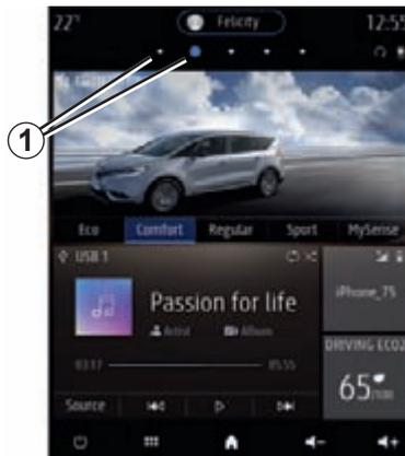
Виджеты позволяют сразу переходить на главный экран нужной функции, а в некоторых случаях — управлять этой функцией с одного из главных экранов (например, переключать радиостанции).
