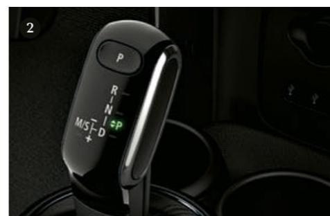
① Режимы движения MINI. ② Электронный рычаг селектора у 7-ступенчатой коробки передач с двойным сцеплением.
