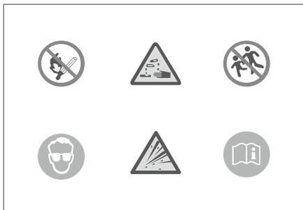
Данная этикетка находится на аккумуляторе, используется для указания, чтобы вы обратили внимание на следующие пункты перед монтажом, разборкой или проверкой аккумулятора:
