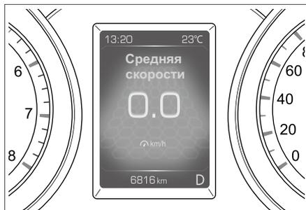
Средняя скорость подсчитывается и отображается при работающем двигателе, в соответствии с накопленным пробегом и пройденным временем во время вождения.
