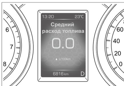
Средний расход топлива рассчитывается и отображается на основе совокупного количества накопленного расхода топлива и количества расхода топлива во время оборотов двигателя.
