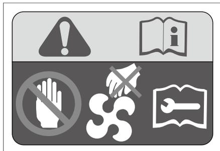
Данная этикетка находится на внутренней планке двигателя, используется для указания «вентилятор охлаждения может работать в любое время, абсолютно нельзя вдевать руку в защитный кожух вентилятора». В противном случае, неожиданный запуск вентилятора может создать тяжелое телесное повреждение.
