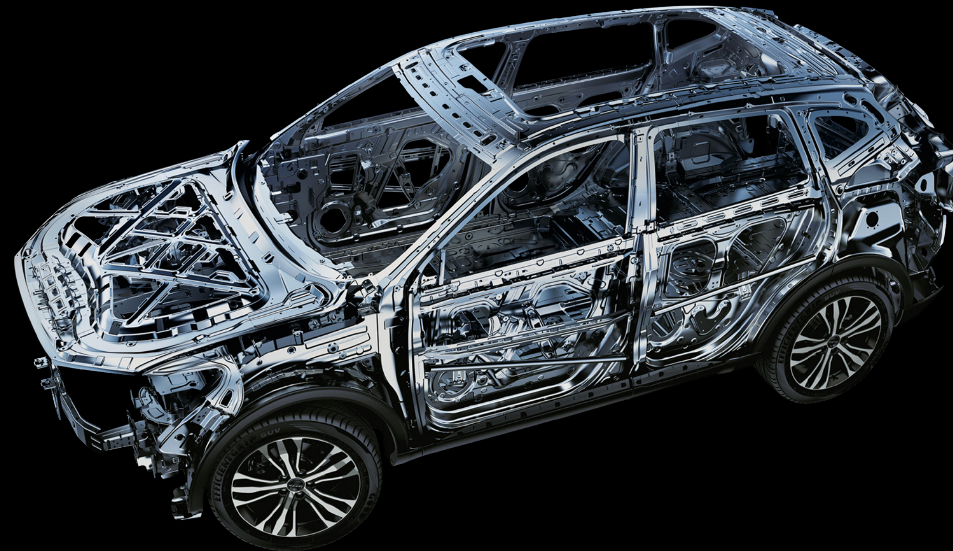
Предохранительная система «панцирной» защиты. Салон автомобиля опоясывает каркас безопасности, созданный из высокопрочной стали
