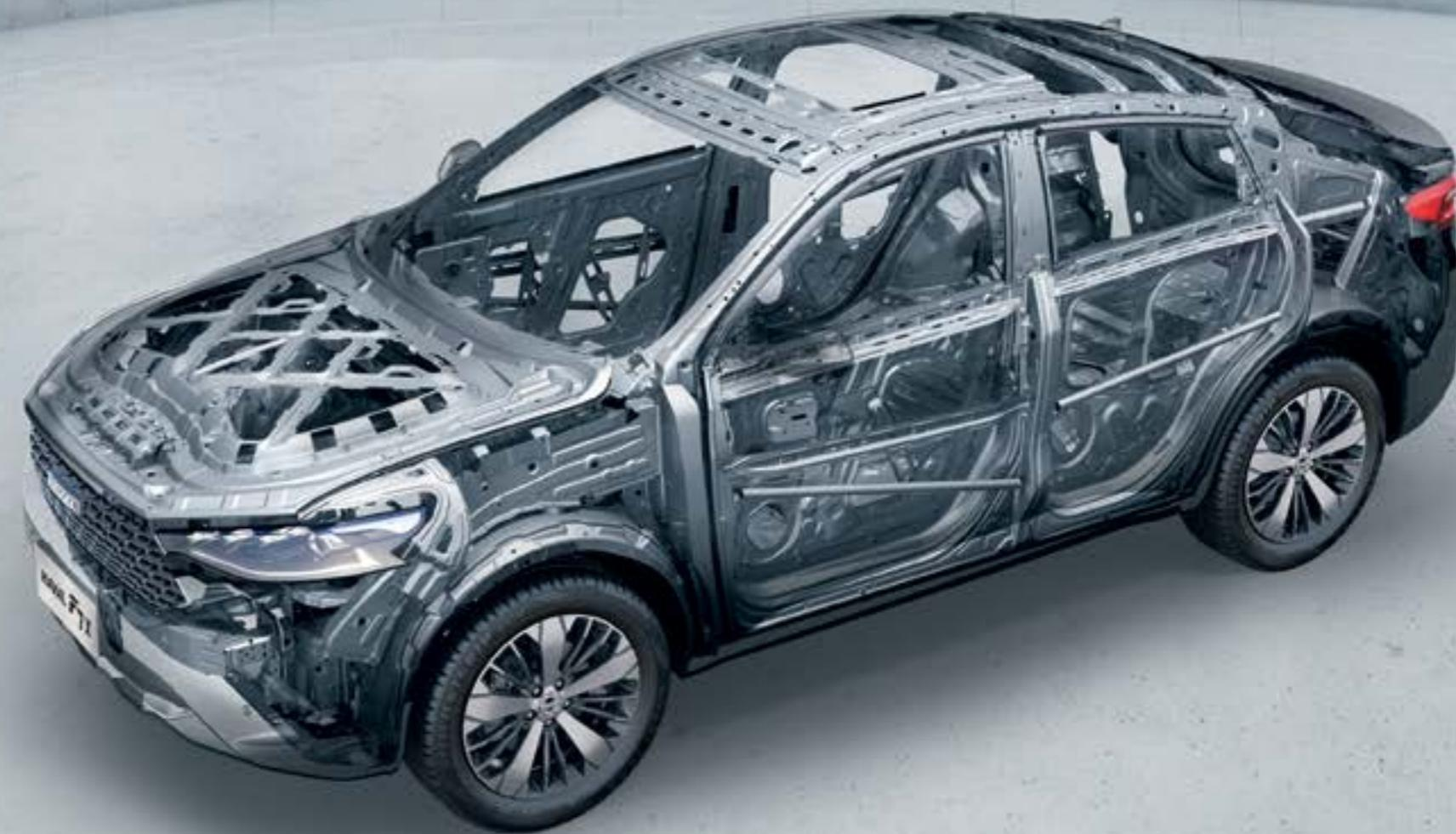
Салон автомобиля опоясывает каркас безопасности, созданный из высокопрочной стали
