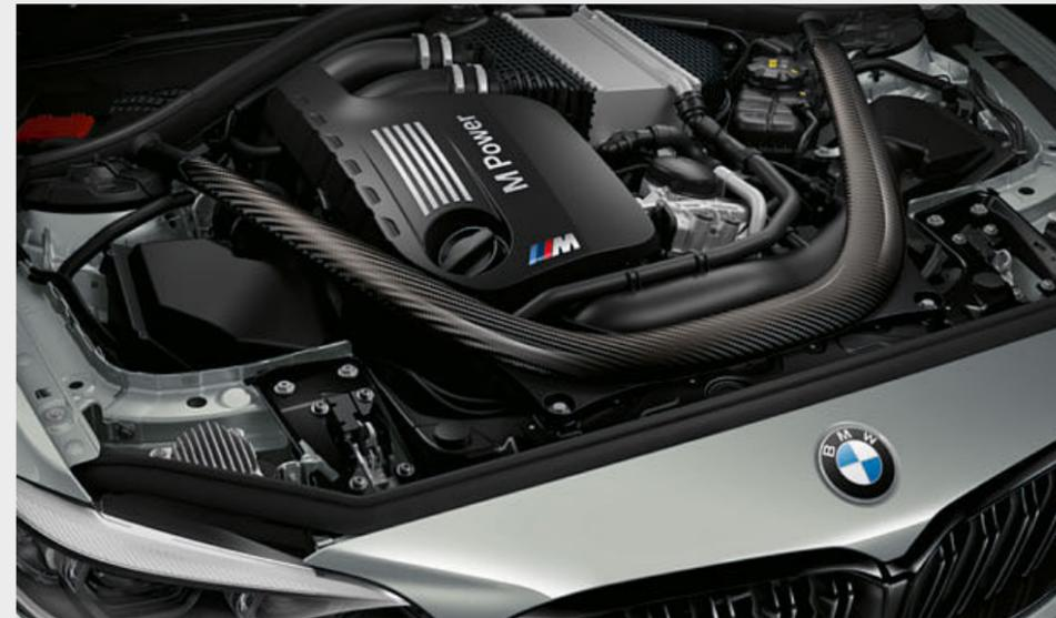
■ Распорка особой формы из углепластика (CFRP), устанавливаемая между опорами передней подвески – важный силовой элемент моторного отсека, позаимствованный у гоночных автомобилей. При массе всего 1,5 кг она значительно усиливает жесткость передней части кузова, благодаря чему повышается точность реакций рулевого управления.
