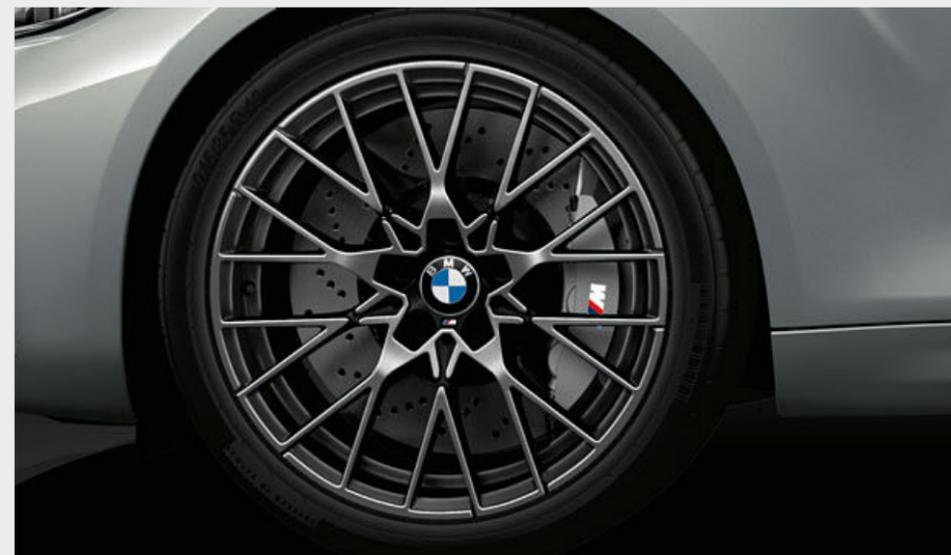
□ 19" легкосплавные диски M Y-spoke 788 M с разноразмерными шинами, кованные, шлифованные, черные. Передние диски 9J x 19 с шинами 245/35 R19, задние диски 10J x 19 с шинами 265/35 R19.
