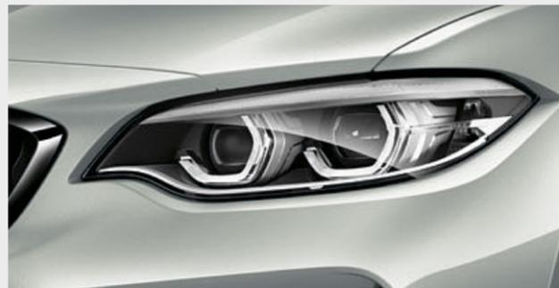
■ Адаптивные светодиодные фары с режимом ближнего и дальнего света наряду с другими функциями включают в себя неослепляющую систему управления дальним светом.
