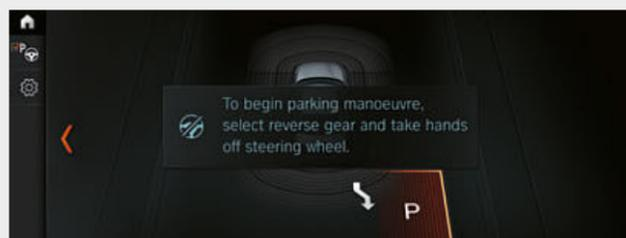
□ Ассистент парковки упрощает выполнение параллельной и перпендикулярной парковки. Система выявляет даже самые тесные места для парковки при проезде мимо них на малой скорости. Когда обнаруживается подходящее место, ассистент парковки принимает на себя управление рулевым колесом, а водитель отвечает за выбор передач и управление педалями акселератора и тормоза.
