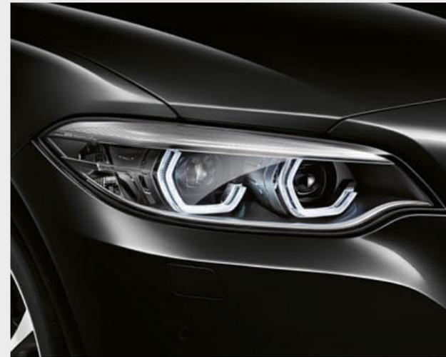
□ Полностью светодиодные адаптивные фары включают в себя указатели поворотов, режим ближнего и дальнего света, а также дневные ходовые огни для обеспечения безопасности и оптимальной освещенности дороги. Ассистент управления дальним светом и адаптивные фары с изменяемой формой световых лучей значительно улучшают видимость в темноте и позволяют управлять автомобилем ночью почти так же комфортно, как днем.
