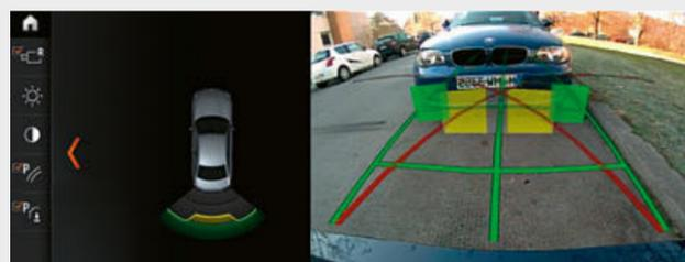
□ Камера заднего вида позволяет лучше ориентироваться при движении задним ходом на скорости ниже 15 км/ч, например, при выполнении парковки. Камера заднего вида отображает пространство, находящееся за автомобилем, на центральном дисплее. Интерактивные направляющие линии для измерения расстояния и радиусов поворотов дополнительно помогают водителю ориентироваться наряду с цветными обозначениями препятствий.
