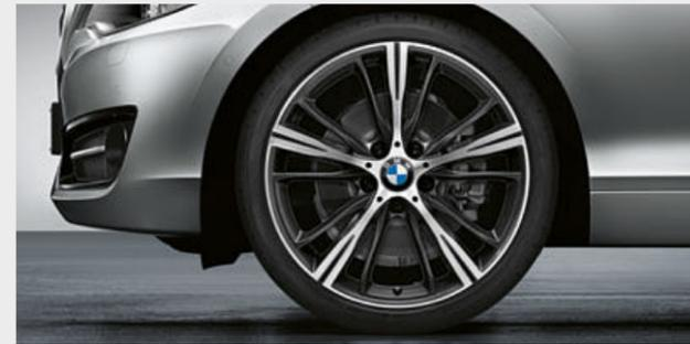
○ 19" легкосплавные диски Star-spoke 660 цвета Orbit Grey, шлифованные на лицевой стороне. Комплект летних колес в сборе с датчиками TPMS и разноразмерными безопасными шинами. Передние диски 7,5J x 19 с шинами 225/35 R19 88Y XL, задние диски 8J x 19 с шинами 245/30 R19 89Y XL.
