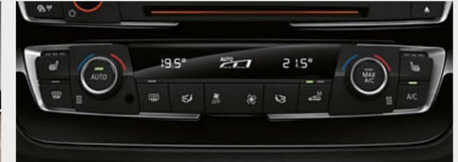
□ Система двухзонного климат-контроля оснащается функцией автоматической рециркуляции воздуха (AAR) с фильтром из активированного угля, а также датчиками запотевания и солнечными датчиками.
