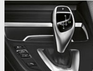
□ 8-ступенчатая спортивная автоматическая коробка передач Steptronic позволяет переключать передачи автоматически или вручную с помощью подрулевых лепестков или рычага селектора коробки передач.
