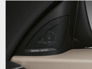
□ В аудиосистему Hi-Fi Harman Kardon с внешним усилителем мощностью 360 Вт, расположенным в багажном отделении, входят 12 динамиков, в том числе два центральных сабвуфера.
