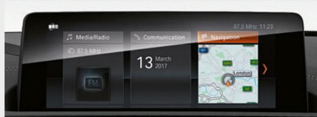
□ Навигационная система Professional включает в себя систему голосового управления, USB-разъем, 8,8-дюймовый цветной ЖК-дисплей и радио BMW Professional с DVD-проигрывателем, а также режим трехмерного отображения карты и 20 Гб встроенной памяти. Управление системой интуитивно и просто осуществляется при помощи сенсорного контроллера iDrive.
