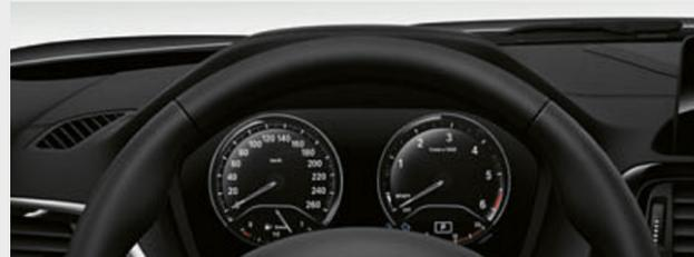
□ Приборная панель с расширенными функциями обеспечивает возможность отображения на информационном дисплее подсказок системы навигации и другой дополнительной информации.
