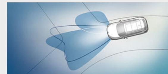
□ **Адаптивные светодиодные фары** с режимом ближнего и дальнего света включают в себя светодиодные указатели поворотов, адаптивную систему изменения формы светового пучка и неослепляющую систему управления дальним светом.
