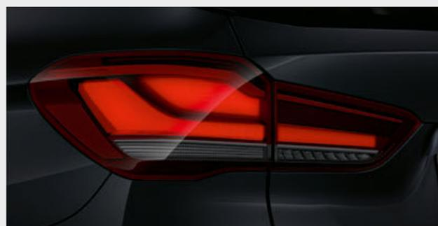
□ Одна часть светодиодных задних фонарей\* характерной L-образной формы установлена на кузове автомобиля, другая – на двери багажного отделения. Функция динамического стоп-сигнала позволяет водителям автомобилей, движущихся сзади, раньше распознать экстренное торможение благодаря мигающим стоп-сигналам.
