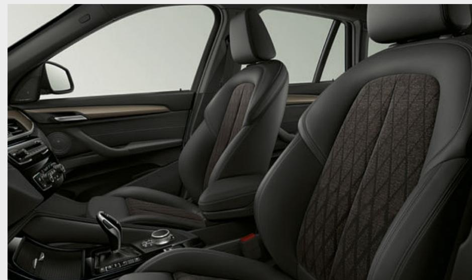
□ Спортивные сиденья для водителя и переднего пассажира отличаются более выраженными валиками боковой поддержки на спинке и подушке, чем на обычных сиденьях, и в сочетании с регулируемой подколенной опорой обеспечивают идеальный комфорт и поддержку тела даже при самом динамичном прохождении поворотов. В дополнение к электрорегулировке ширины спинки водительское сиденье также оснащается механической регулировкой глубины.
