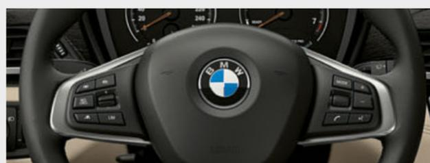
□ В зависимости от оснащения кнопки на многофункциональном рулевом колесе позволяют пользоваться телефоном, функцией голосового управления и аудиосистемой. В число управляемых функций также входит ручная ограничитель скорости. Он может использоваться для установки ограничения скорости, например, 50 км/ч, для движения в городе.
