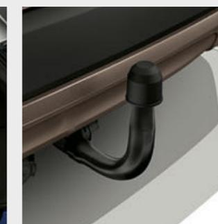
□ Когда тягово-сцепное устройство со съемной шаровой головкой не используется, оно не ухудшает спортивный внешний вид задней части автомобиля.
