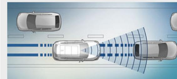
□ **Система предупреждения о столкновении\*** с функцией торможения на городских скоростях предупреждает водителя об опасности аварии, а в экстренных ситуациях совершает автоматическое торможение.
