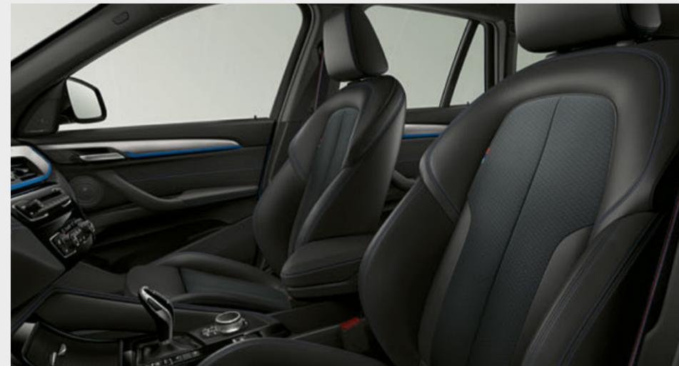
■ Спортивные сиденья для водителя и переднего пассажира отличаются более выраженными валиками боковой поддержки на спинке и подушке, чем на обычных сиденьях, и в сочетании с регулируемой подколленной опорой обеспечивают идеальный комфорт и поддержку тела даже при самом динамичном прохождении поворотов. В дополнение к электрорегулировке ширины спинки водительское сиденье также оснащается механической регулировкой глубины.
