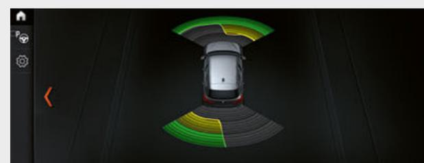
□ Передние и задние датчики сигнализации аварийного сближения при парковке\* упрощают парковку и маневры в ограниченном пространстве. О расстоянии до препятствий можно судить по звуковым предупреждениям, а также по индикации на контрольном дисплее.
