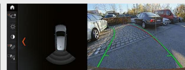
□ Камера заднего вида\* позволяет лучше ориентироваться при движении задним ходом со скоростью ниже 15 км/ч, например, при выполнении парковки. Камера позволяет отображать пространство, находящееся за автомобилем, на контрольном дисплее. Интерактивные направляющие линии для измерения расстояния и радиусов поворотов оказывают Вам дополнительную помощь при маневрировании. Препятствия отображаются в цвете.
