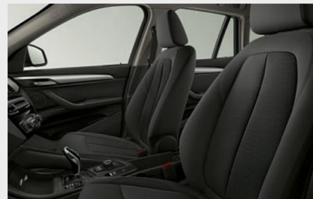
■ Вручную можно регулировать высоту и наклон спинок стандартных передних сидений, а также продольное положение сидений и высоту подголовников.
