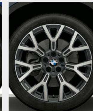
□ 19" легкосплавные диски Y-spoke 580 Bicolour Orbit Grey с шинами Runflat, шлифованные. Диски 8J x 19 с шинами 225/45 R19.
