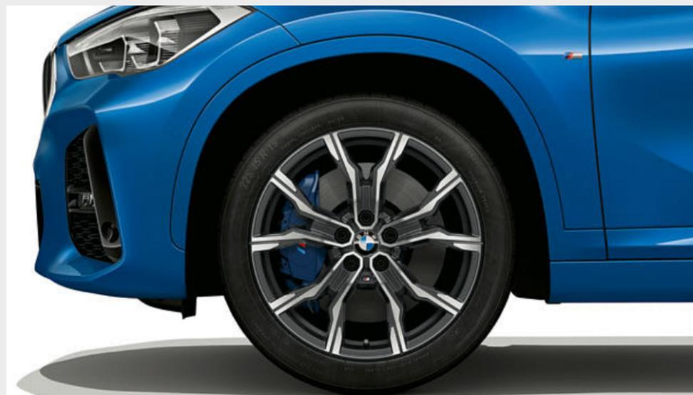
□ 19" легкосплавные диски M Double-spoke 816 M Bicolour Orbit Grey, шлифованные. Диски 8J x 19 с шинами 225/45 R19.<sup>1</sup>
